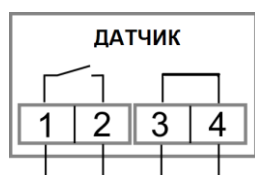
Рис.2 Электрическая схема датчика
