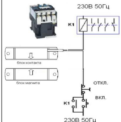
Пример схемы управления двумя нагрузками контактами KM-250-P «ARTOL»
